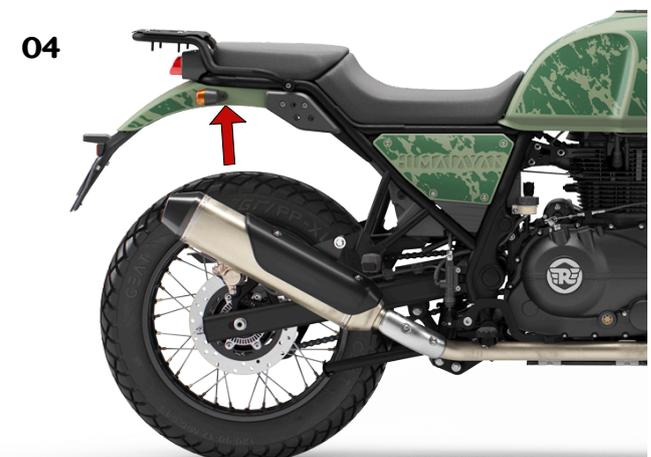
**02 - Retire os parafusos localizados abaixo do para-lama traseiro, Fig. 03 e 04;**
