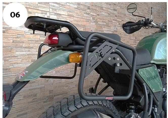
**03 - Posicione o afastador de alforje, inicie com a lateral esquerda, a parte superior deve ficar entre o quadro e o para-lama traseiro, e a chapa frontal deve ficar posicionada na furação existente na lateral. Fixe o conjunto com paraf. cab. cilind. MA 06 - 1,00 X 30 INOX (rosca total) e arruela lisa 1/4 (6,4 x 17 x 1,2 mm) no lugar dos parafusos retirados na etapa anterior, Fig. 05 e 06;**
