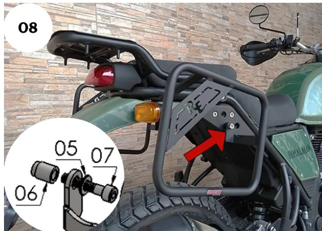
04 - Na parte central do alforje, utilize a paraf. cab. cilíndrica MA 08 - 1,25 X 40 INOX (rosca parcial), arruela lisa M8 (8,40 x 17,00 x 1,50 mm) e espaçador Ø Ext. 14,10 x Ø Int. 8,30 x Comp. 18,00 rebaixo, Fig. 07 e 08;
