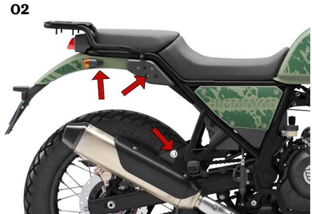
**01 - Identifique os pontos de apoio do afastador de alforje na moto, Fig. 01 e 02**
