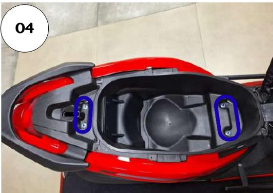
04 - Remova os parafusos destacados na imagem;
