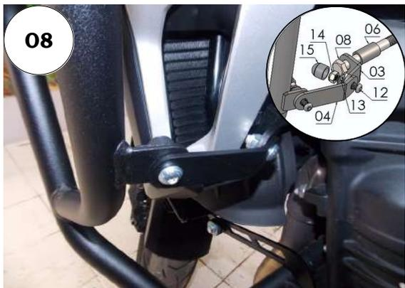
08 - Na parte central, utilize a chapa de reforço dobrada, parafuso abaulado MA 08 - 1,25 x 20 INOX RT, arruela M8 e porca travante (DETALHE A1);
