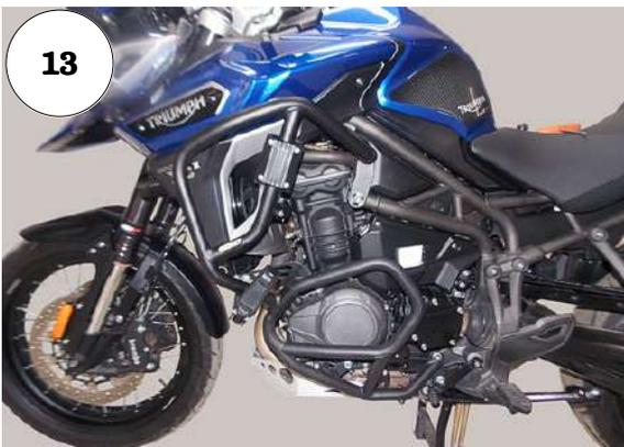
13 - Após a instalação de todos os itens confira a posição e alinhamento dos mesmos e dê o aperto final em parafusos e porcas;
