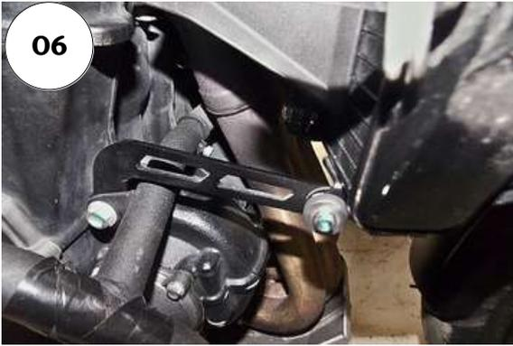
06 - Reinstale os itens originais da moto (suporte radiador, laterais e acabamentos plásticos);
