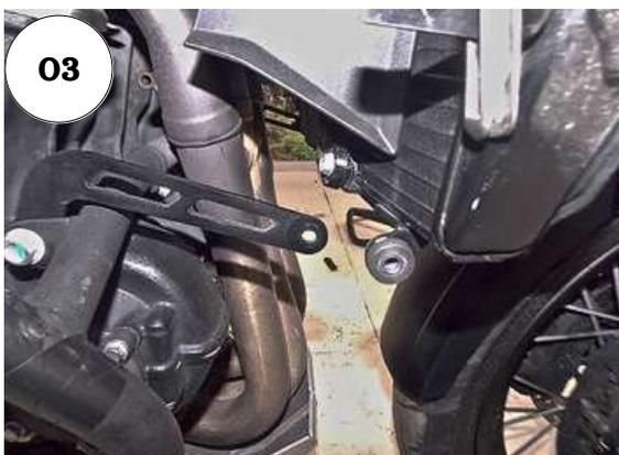
03 - Retire os parafusos inferior do suporte do radiador para facilitar o aperto das cantoneiras de fixação dos procedimentos seguintes;
