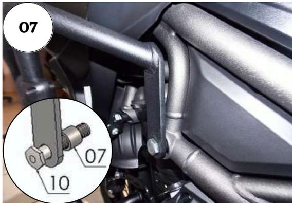
07 - Posicione a lateral esquerda do protetor de carenagem conforme os pontos de fixação;
