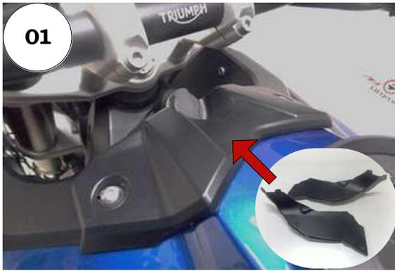
01 - Remova a capa central do tanque, e posteriormente as capas internas das laterais;
