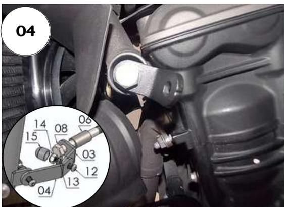
04 - Retire o parafuso frontal esquerdo do motor, em seu lugar instale a cantoneira de fixação. Utilize espaçador Ø Ext. 17,95 x Ø Int. 12,20 x Comp. 30,00 mm e parafuso sextavado MB 12 - 1,25 x 110 RP (DETALHE A1);
