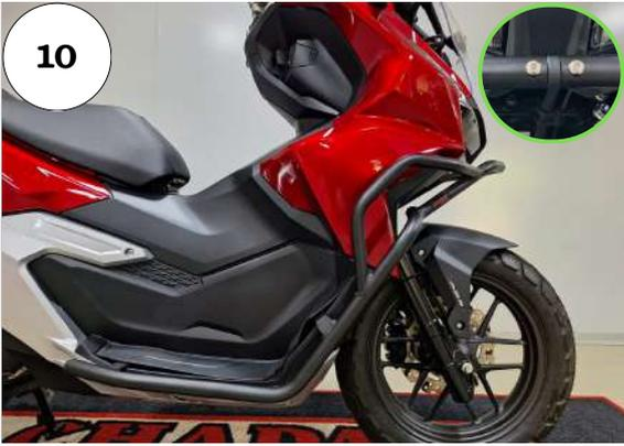
10 - Na lateral oposta posicione o protetor conforme união instalada e os pontos de fixação, faça a fixação utilizando parafuso abaulado ALLEN MA 06 - 1,00 X 16 INOX CL A2-070 e os parafusos chatos ALLEN MA 06 - 1,00 X 40 INOX (ROSCA TOTAL)
