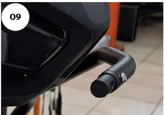
09 - Faça a fixação com da união com a lateral instalada do protetor, utilize parafuso abaulado ALLEN MA 06 - 1,00 X 16 INOX CL A2-070;
