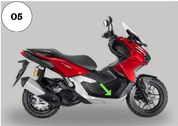
05 - Remova o emborrachado para acesso aos pontos de fixação do PROTETOR CARENAGEM HONDA ADV 160 2025+ (PFM);
