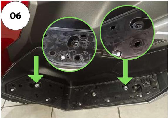
06 - Retire os parafusos indicados pelas setas; Repita o procedimento com a lateral oposta;
