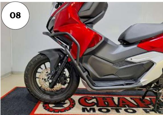
08 - Posicione o protetor de carenagem em um das laterais, utilize para fixação os parafusos chatos ALLEN MA 06 - 1,00 X 40 INOX (ROSCA TOTAL);
