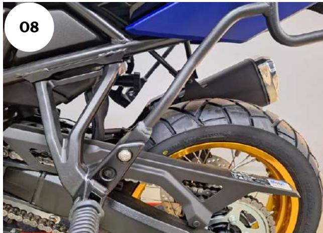
04 - Inicie a fixação do produto pelo parafuso inferior, utilize parafuso cab. abaulada, arruelas e porca travante, Fig. 07 e 08;
