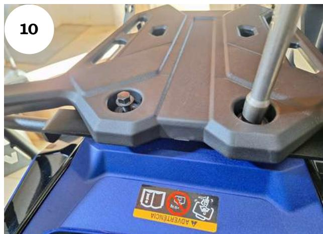
05 - Adicione a alça do passageiro original e a fixe acima ao afastador de alforge na moto utilizando os parafusos originais, Fig. 09 e 10;
