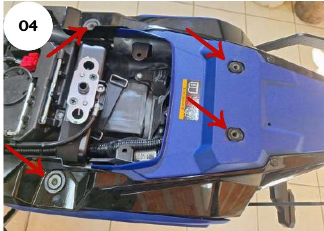
02 - Retire o banco da moto e os parafusos indicados acima, reserve-os pois serão utilizados na montagem, ao fim remova o bagageiro original, Fig.03 e 04;
