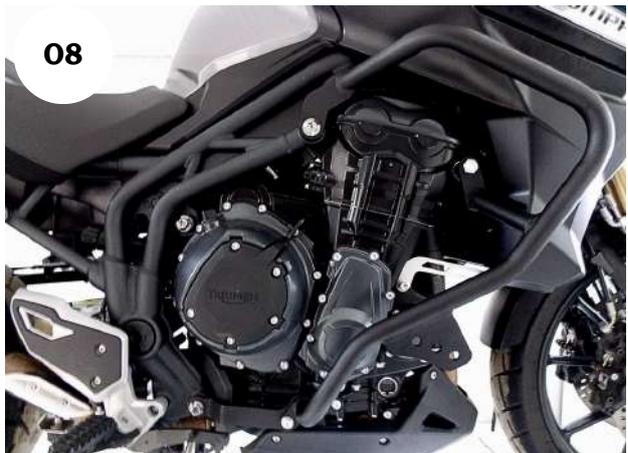
06 - Faça a união do reforço inferior com a lateral direita, utilize Arruela lisa M8 e Parafuso abaulado MA 08 x 1,25 x 20 INOX RT (DETALHE LD-B3), Fig. 07 e 08;
