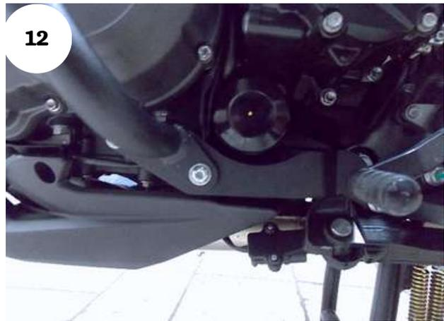
08 - Instale o protetor esquerdo na moto, na parte frontal utilize o Espaçador Ø Ext. 17,95 x Ø Int. 12,20 x Comp. 30,00 mm e Parafuso sextavado MB 12 – 1,25 x 110 RP (DETALHE LE-B1). Na parte de trás utilize o espaçador de 20 mm e o parafuso original que anteriormente era fixado na parte frontal do motor (DETALHE LE-B2), Fig. 11;
