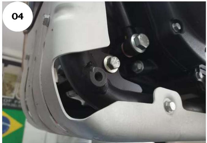
02 - Remova o acabamento na parte central do quadro, e retire o parafuso que fixa a parte frontal do motor ao quadro. Para os modelos anos 2022 e superiores, será necessário fazer um leve afrouxamento dos parafusos que fixam o sistema de escapamento Fig. 03 e 04;
