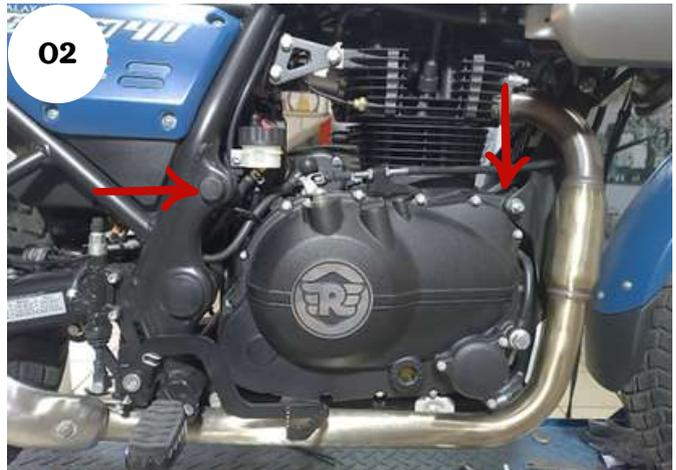
01 - Identifique o ponto de apoio do protetor dianteiro, conforme indicado pela seta nas figuras 01 e 02;
