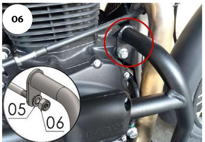
03 - O conjunto deve ser montado primeiramente pela direita. Posicione o protetor de motor (item 01) na furação correspondente, na parte superior instale com parafuso M10 x 180 e arruela M10 (itens 04 e 05), na parte inferior fixe com arruela M8 e parafuso M8 x 16 (itens 07 e 08), Fig. 05 e 06;
