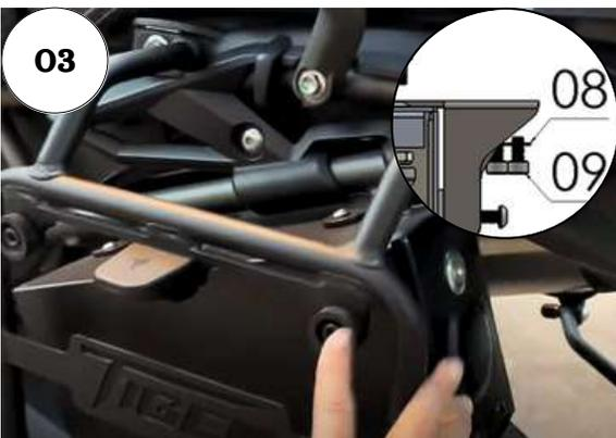
03 - Para fixação do suporte de fixação menor no quadro utilize parafuso cilíndrico ALLEN MA 06 -1,00 X 12 INOX RT e arruela lisa 6,00 MM ZB (6,40 x 12,5 x 1,20); Repita com o suporte de fixação maior;
