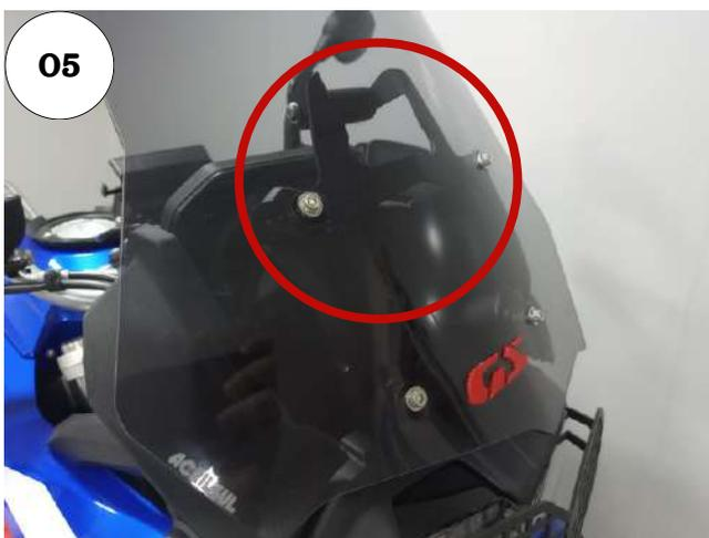
**05 - Na parte superior interna da bolha adicione a chapa de fixação e na parte externa a arruela lisa 3/16 inox e o parafuso cab. cilíndrica MA 05 - 0,80 x 20 INOX (rosca total) (Detalhe B), Fig. 05 e 06;**
