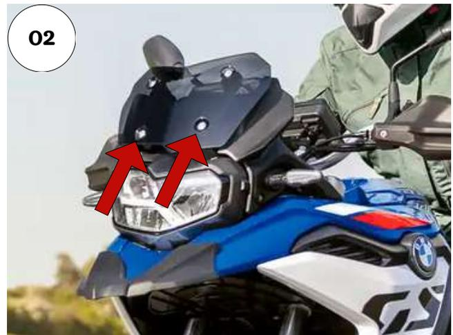
**02 - Remova os parafusos na parte inferior da bolha frontal, Fig. 02;**
