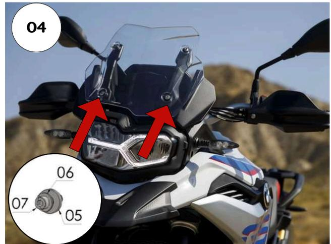
**04 - Na parte inferior adicione o parafuso cab. cilíndrica MA 05 - 0,80 x 20 INOX (rosca total), arruela lisa 3/16 inox, e na parte interna da bolha a arruela lisa 1/4 x 3,00 mm (preta) (Detalhe C), Fig. 04;**
