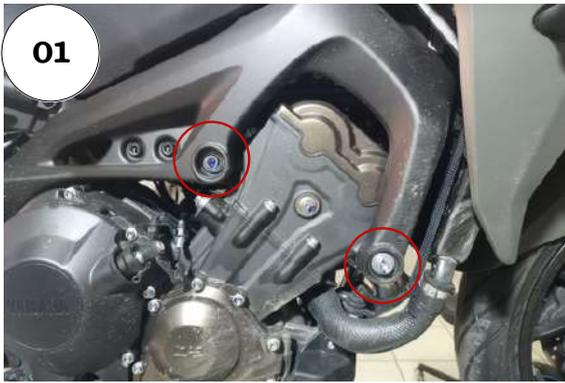
01 - Retire os dois parafusos que fixam o motor ao quadro, inicie pelo lado direito da moto;
