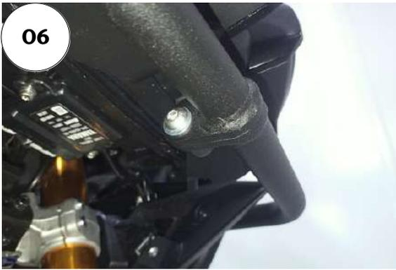
06 - Faça a união frontal das duas laterais, fixe o conjunto utilizando arruelas M8, parafuso abaulado MA 08 - 1,25 X 25 INOX rosca total e porca travante M8 (Detalhe A1);
