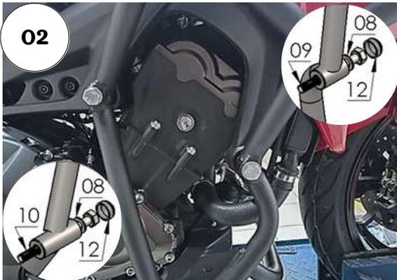
02 - Instale o protetor lado direito, use as arruelas M 10, na parte frontal utilize o parafuso sextavado SEXTAVADO MB 10 - 1,25 X 90 rosca parcial e na parte traseira o parafuso MB 10 x 110 (item 10), Fig. 02 e detalhes C1 e D1;
