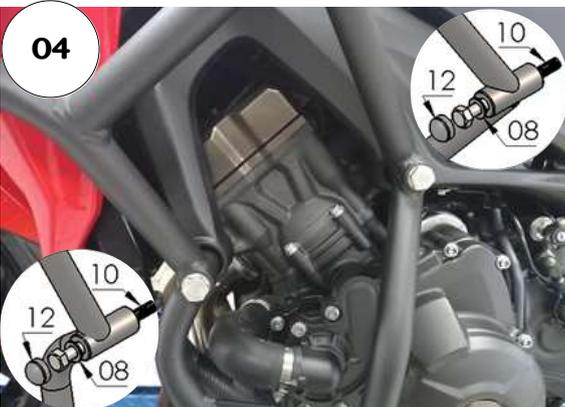
04 - Instale o protetor lado esquerdo, utilizando as arruelas M10 e os parafuso sextavado MB 10 - 1,25 X 110 rosca parcial, (Detalhes E1 e F1);
