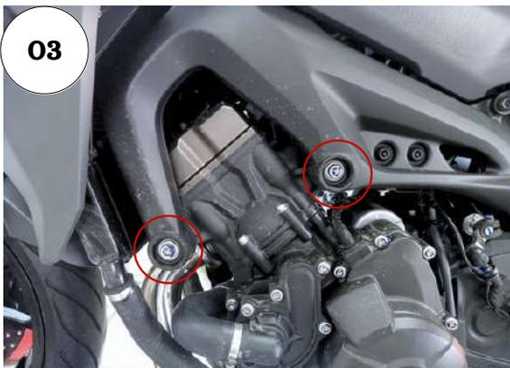
03 - Retire os dois parafusos que fixam o motor ao quadro, agora do lado esquerdo;
