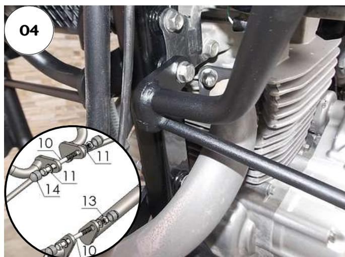
**02 - Instale primeiramente as laterais do protetor de motor, utilize os Parafuso sextavado MA 08-1,25 x 80 mm, Arruela lisa M8 e Porca sextavado travante baixa M8-1,25 mm, (Detalha A1), Fig. 03 e 04;**
