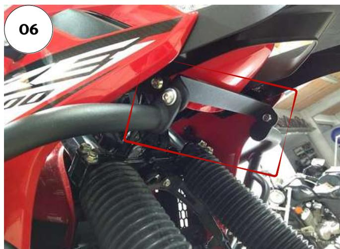
**03 - Abaixo do paralama dianteiro, instale a chapa reforço central, juntamente com os Parafuso cab. Abaulado MA 08-1,25 x 20 mm, Arruela lisa M8 e Porca sextavado travante baixa M8-1,25 mm (DETALHE B1), Fig. 05 e 06;**
