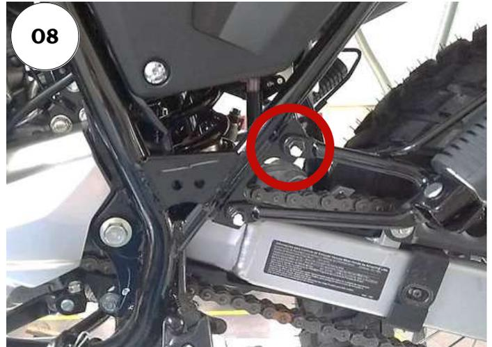
**04 - Remova o parafuso superior do suporte de pedaleira do passageiro, Fig. 07 e 08;**
