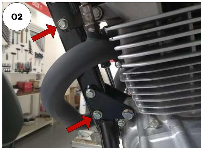
**01 - Identifique e remova os dois parafusos que prendem o motor no quadro, Fig. 01 e 02;**
