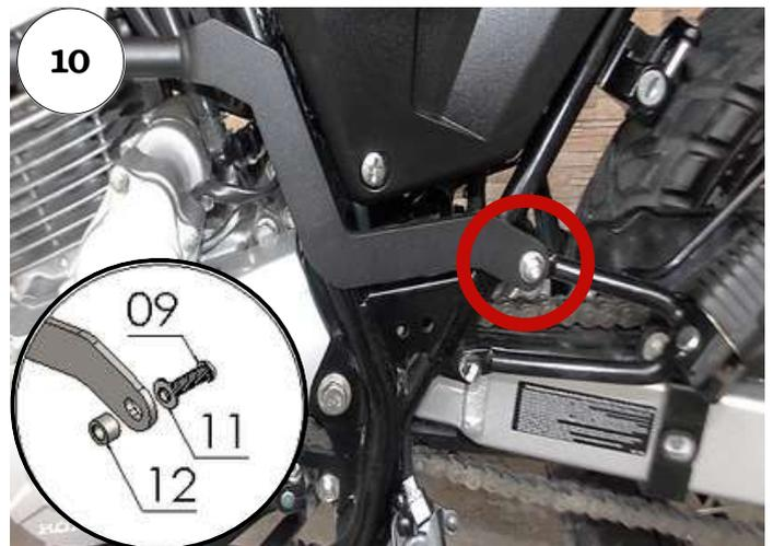
**05 - Instale as hastes de reforço em suas respectivas laterais. Na união com o protetor, utilize Parafuso cab. Abaulado MA 08-1,25 x 20 mm, Arruela lisa M8 e porca travante M8 (DETALHE C1). No suporte de pedaleira, fixe com Parafuso cab. Abaulado MA 08-1,25 x 35 mm, arruela M8 e Espaçador Ø Ext. 14,10 x Ø Int. 8,30 x Comp. 9,00 (DETALHE D1), Fig. 09 e 10;**
