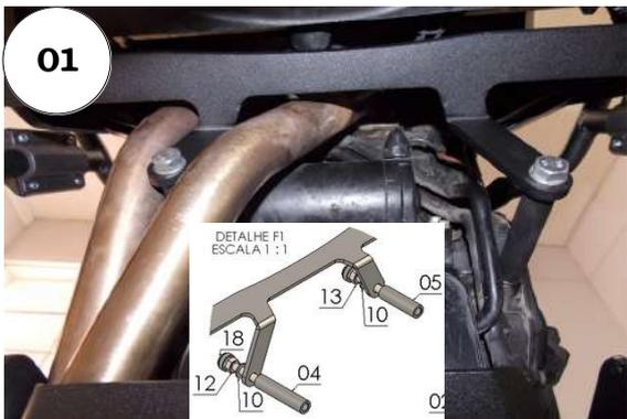
01 - Inicie a montagem pelo reforço central, fixe-o na parte frontal do motor utilizando os Espaçador Ø Ext. 17,90 x Ø Int. 10,60 x Comp. 80,00 mm, e Espaçador Ø Ext. 17,90 x Ø Int. 10,60 x Comp. 60,00 mm, arruela lisa M10, Parafuso sextavado MA 10 - 1,50 x 110 RP e Parafuso sextavado MA 10 - 1,50 x 90 RP;
