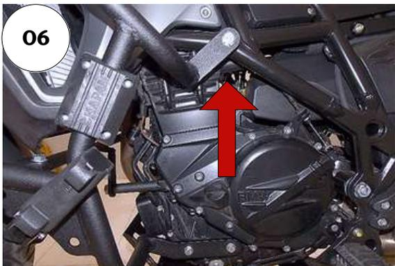
06 - Faça a união do reforço central com as laterais do protetor, use arruela M8, Parafuso abaulado MA 08 - 1,25 x 20 INOX (rosca total) e porca M8 travante, (DETALHE F2);
