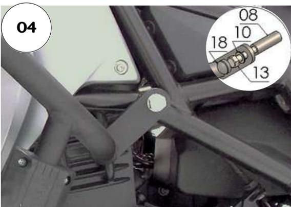
04 - Remova a tampa plástica e parafuso originais no lado esquerdo do quadro;
